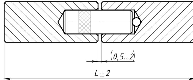
"Петля гаражная без шара" - шариком не комплектуется, при этом зазор 0,5...2 мм - отсутствует.
